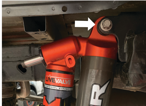
Fig. 47: Remove the upper shock bolt.
