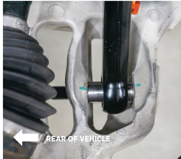
Fig. 21: Torque the LCA bolt.
