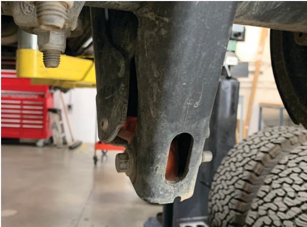
Fig. 46: Remove lower shock mount bolt.
